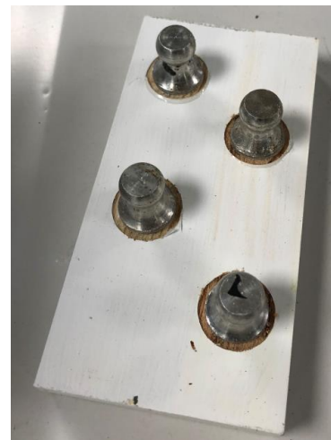
Figure 24: ébavurage de la colle autour des plots pour test positest
