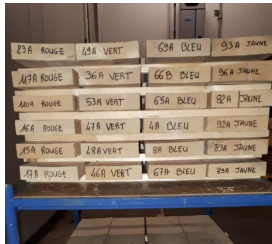
Figure 14 : éprouvettes de bois lamellé collé sélectionnées pour les essais de résistance au cisaillement et à la délamination des plans de collage
