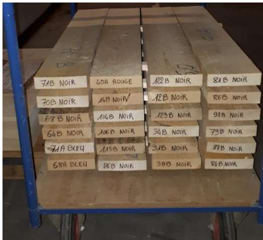
Figure 14 : éprouvettes de bois lamellé collé sélectionnées pour les essais de résistance au cisaillement et à la délamination des plans de collage
