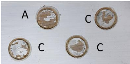
Figure 25: exemple des faciès de rupture du film de finition lors du test Positest
